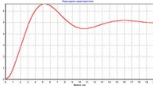
Рис.1. Переходная характеристика колебательного звена
