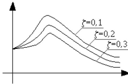
Рис. 4. Зависимость АЧХ колебательного звена от коэффициента затухания
