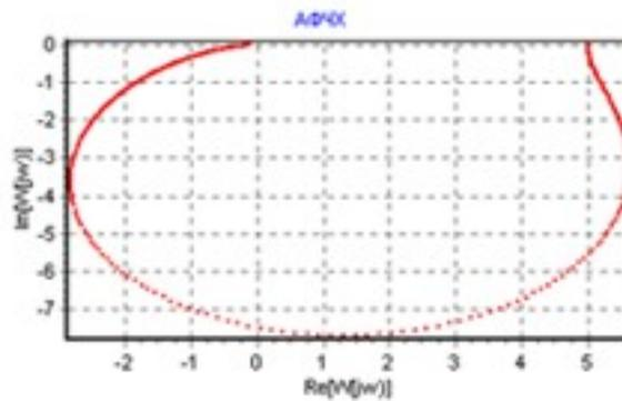
Рис. 2. Годограф амплитудно-фазочастотной характеристики колебательного звена
